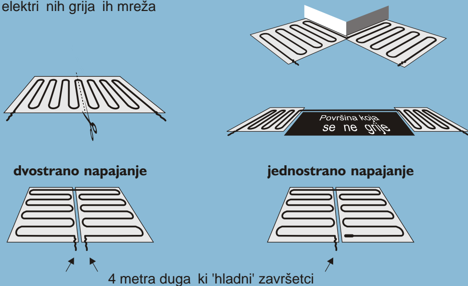
Slika 3. Primjeri postavljanja podnih električnih grijalnih mreža
