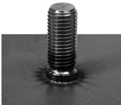
Bolzenschweißen mit Hubzündung bei Verwendung von Keramikringen
