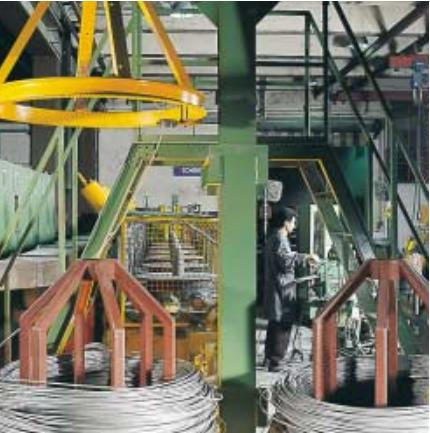
Grobdrähte werden im Werk Werdohl-Bärenstein auf modernen Tastrollen-Tänzer-Mehrfachtrockenziehmaschinen hergestellt.
