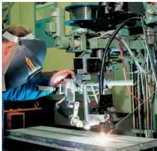
Vollmechanisierte MAG Schweißung
