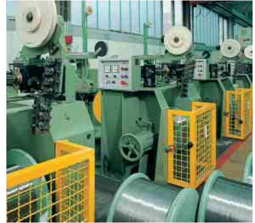
Produktion von MIG-Drähten mit großen Casts, kleiner Helix und sauberster Oberfläche in speziellen Nachziehmaschinen - in Linie mit dem Glühen.
