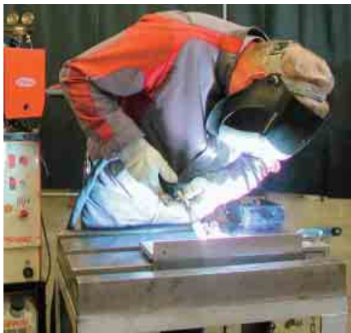
Manuelle MSG Schweißung
