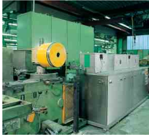
Fertigziehen und In-Line-Drahtreinigung für saubere Drahtoberflächen.
