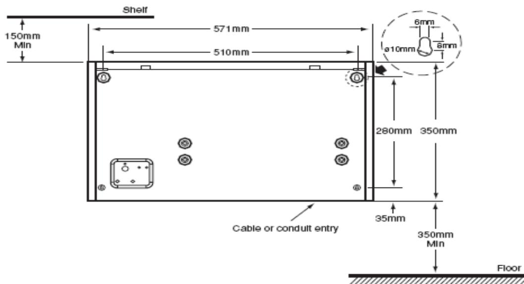
**WF zidni montirani greaci so ventilator**
