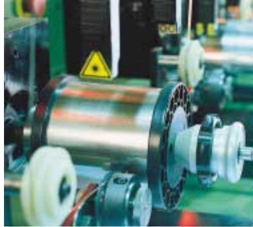
Spuler mit Lasersteuerung. Laser-controlled wire spooler.
