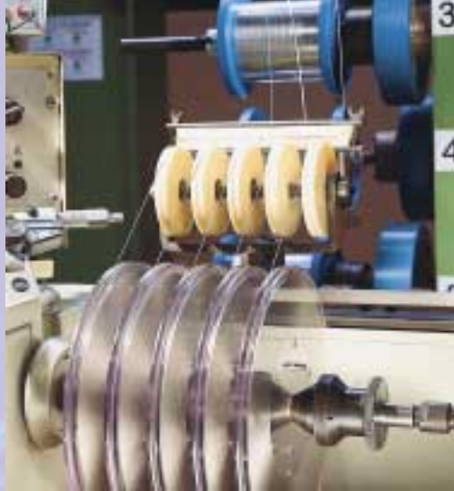
Flachdrahtumspulung auf Monoreels.
