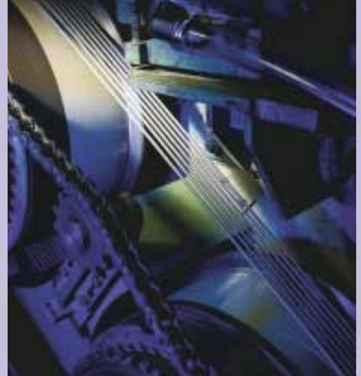
Für höchste Oberflächenanforderungen: schlupf- und torsionsfreies Ziehen von Drähten auf Spezialmaschinen.
