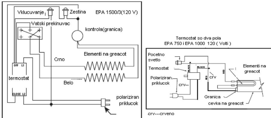
**VE MOLIME ZABELEZETE:**Ako vasiot greac ima thermostat koj e obelezan so OFF(iskluceno) pozicija,edinkata e opremana so thermostat so dva pola.Nema da se sluci nikakvo greenje ako thermostatot ke bide na OFF(iskluceno) pozicija.
