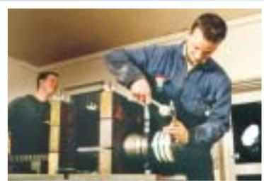
Montage der neuen Dichtelemente
