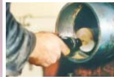
Polieren des Zylinderrohres bzw. des Einbauraumes
