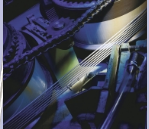
Für höchste Oberflächenanforderungen: schlupf- und torsionsfreies Ziehen von Drähten auf Spezialmaschinen.
