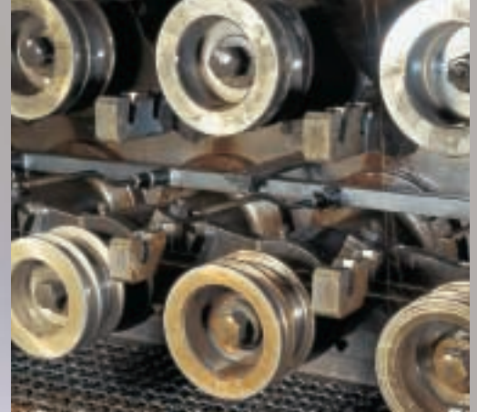
Ziehen von Feindrähten aus Hochleistungslegierungen auf Doppeldraht-Ziehkonen im Nasszug.
