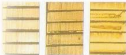
B10 Nagorela mesta sa svetlim tačkama različite veličine i učestanosti. Uzrok: Varničenje ispod četkice
