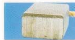
S13 Sagorevanje nailazeće ili odlazeće lamele Uzrok: Izrazito varničenje zbog ovalnosti kolektora, malog pritiska ili nepodešenog držača
