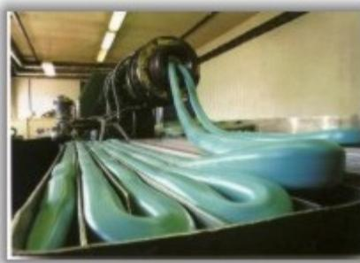
Gumene obloge su zavisno od vrste materijala, otporne na temperaturu od -20 °C do +250 °C, imaju max. izdržljivost do 110 KN/m, otporne su na dejstvo kiselina, baza, ulja, benzina, petroleja, ketona i acetata. Obrada gumenih obloga valjaka vrši se putem struganja i brušenja, kao i prema specifičnim zahtevima za obradu površine (brušenje, bombiranje, rilovanje, žljebovanje, usecanje navoja, pravljenje spirale, specijalne forme itd).
