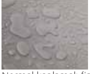
Normal kaplamalı fin yüzeyinde oluşan birikintiler.
