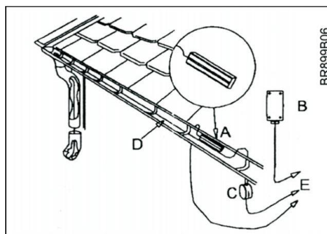
Povezivanje senzora ETOR na termostat ETO
