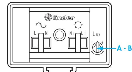
**(I) ATTENZIONE:** l'interruzione del carico avviene tra il morsetto L ed L1 e tra il N ed N1. NON sono necessari ulteriori ponticelli esterni. Eseguire i collegamenti elettrici secondo lo schema, assicurandosi che il pressacavo serri la guaina del cavo. Tipo cavo consigliato: H07RN-F (2x1 mm<sup>2</sup>...2x2,5 mm<sup>2</sup>) o similiari.
