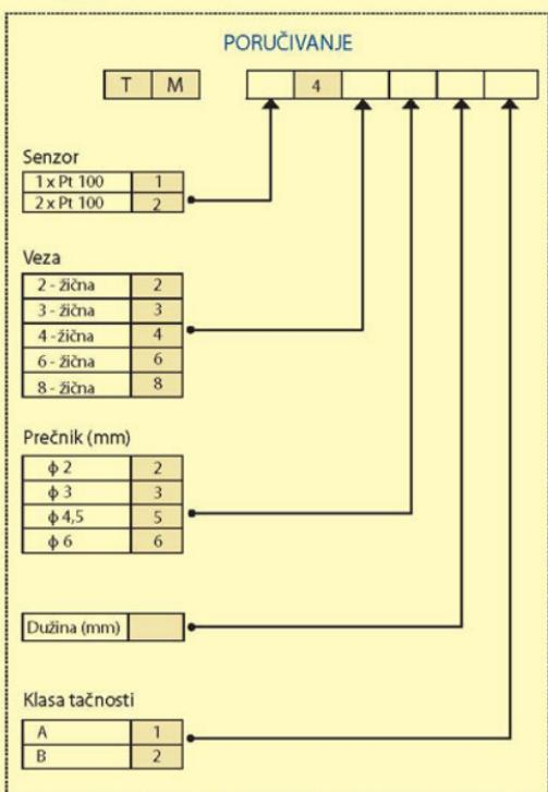
Electrolux otporni termometri
