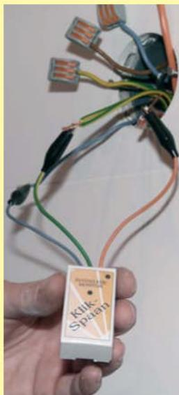
Standardno se u setu isporučuje i Dojavljivač-monitor za zaštitu od oštećenja. Ovaj praktičan aparatič mjeri vaše podno grijanje jedanput u sekundi. Dojavljivač kontrolira da li se otpor izolacije i elemenata možda promjenio u odnosu na početne vrijednosti, i signalirat će ako je do toga došlo. Na ovaj način ćete već za vrijeme instalacije biti obaviješteni o mogućoj šteti, umjesto da je otkrijete poslije, kad su keramičke pločice već postavljene.
