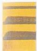
T16 Jasno definisane tamne površine sa nagorelim ivicama lamele Uzrok: Izdignuta izolacija (vidi L6)
