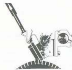
Upotreba dinamometra pri merenju kontaktnog pritiska.
