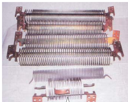
Отпорници за кочење и шентирање EMW 412/416 - Тролебус со омски вредности: 0.161Ω, 0.203Ω, 0.308Ω, 0.49Ω, 0.32Ω, 1.23Ω, 0.79Ω, 0.952Ω, 0.221Ω.
