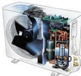
Spoljašnja jedinica se sastoji iz kompresora, isparivača ili kondenzatora (razmenjivači toplote) Kada klima uređaj radi u režimu hlađenja kondenzator se zagreva i toplota se predaje pomoću ventilatora.
