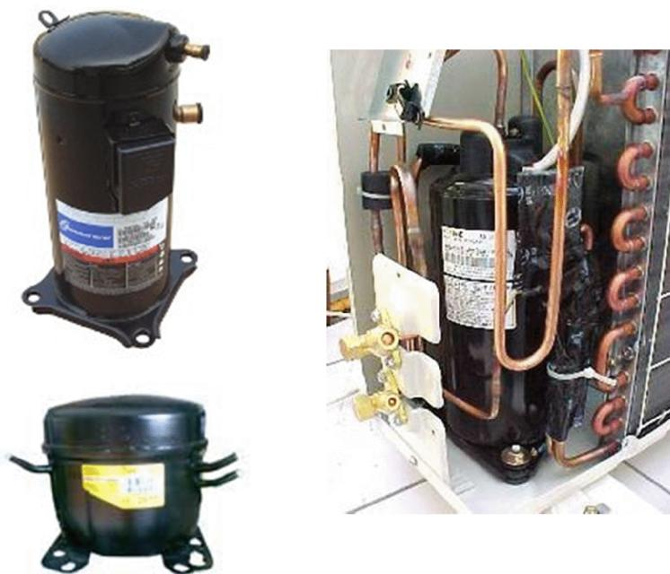
Kompresor je najosetljiviji, ujedno i najskuplji deo u klima uređaju. Nalazi se u spoljnoj jedinici split sistema i služi za povećanje radnog pritiska freona. Od kavliteta kompresora zavisi i vek trajanja uređaja, a od kapaciteta jačina hlađenja (grejanja) prosotrije.
