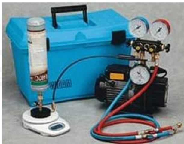
Pod pojmom vakumiranje se podrazumeva izvlačenje vazduha iz sistema da bi se nakon toga pustio freon u sistem. Tako se mogu proveriti i svi spojevi cevi u sistemu pre puštanja freona. Ako bi se slučajno vazduh nasao u sistemu, klima uređaj bi lošije radio, a ako se u vazduhu nađu čestice vlage može i da se ošteti. Znači ovaj proces je neophodan prilikom montaže klime.
