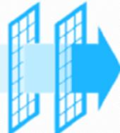
Filter za pročišćavanje vazduha sakuplja **najmanje čestice prašine i grinje** veličine 0,01 mikrona i sprečava širenje **bakterija i virusa**. Filter ima dvije strane sa zračnim-elektrostatičnim filterom sa prednje strane i filterom sa aktivnim ugljenom sa zadnje strane.
