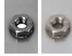
Mutterschweißen mit Standardmuttern in radialsymmetrischem Magnetfeld auf gelochte und ungelochte Bleche von M8 - M12
