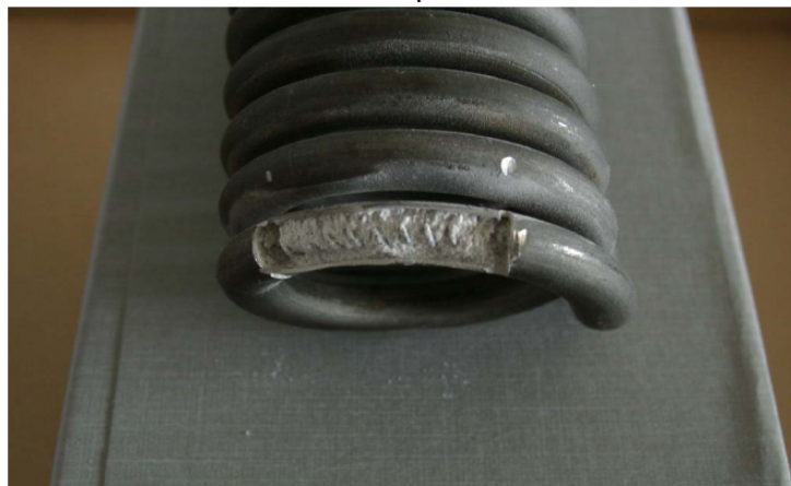
Radijalne i unutrašnje pukotine
